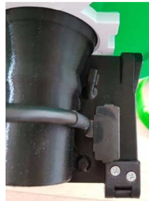
6. Remplacez le capot, il doit être plaqué contre le boîtier noir.
